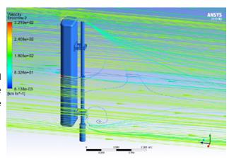
Figura 4: Simulación CFD del diseño mejorado de la antena de CommScope
