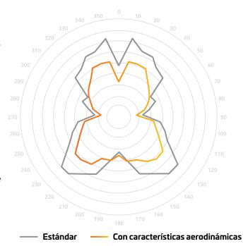
Figura 9: Resultados de la prueba de túnel de viento con tapas de antena mejoradas y nodos de superficie que reducen la estela
