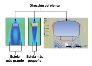
Figura 3: Comparación de CFD de caja rectangular versus el diseño mejorado de la antena de CommScope
