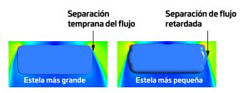
Figura 7: Separación mejorada del flujo de aire con nodos de superficie aerodinámicos
