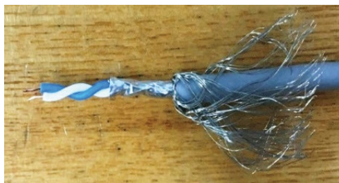
Figura 2: Exemplo de cabeamento blindado do tipo IEC 61156-11
