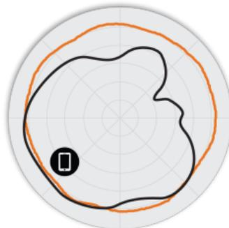
FIGURA 4 Padrões de antena de elevação R610 2,4 GHz
