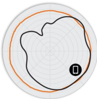
FIGURA 3 Padrões de antena do azimute R610 5 GHz
