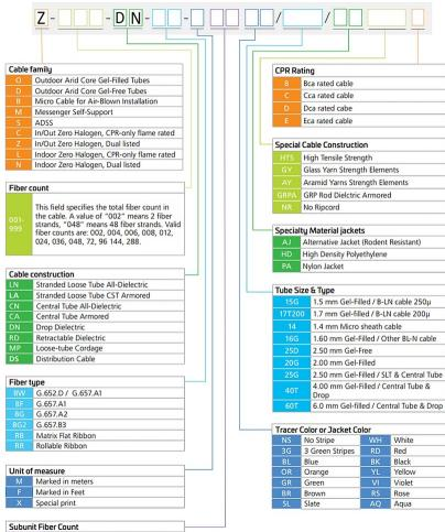
01-24 "01" means 1 fiber per sub unit (tube).
